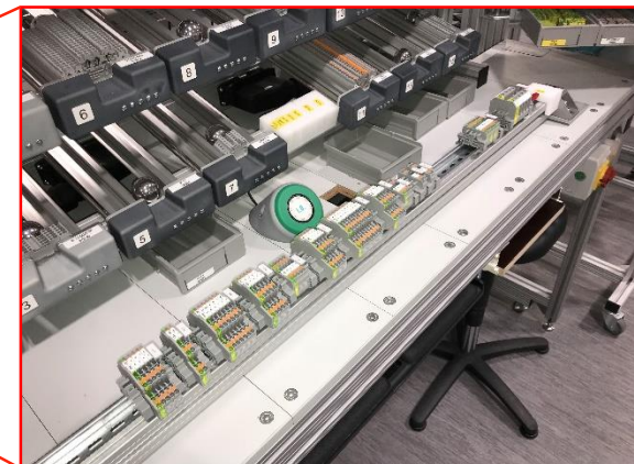
Montierte Klemmenleiste auf der Arbeitsfläche
