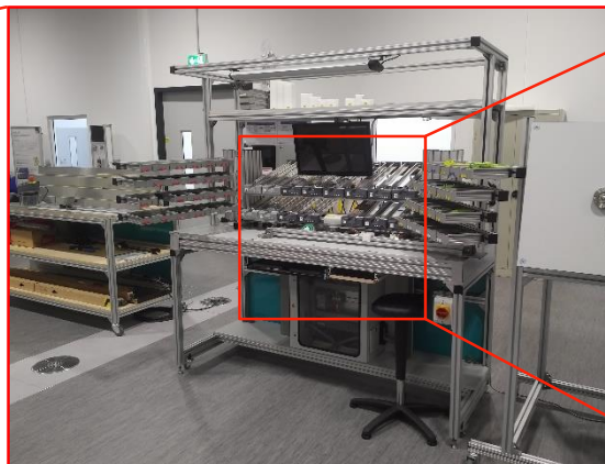
Arbeitsstation zur Klemmenbestückung
