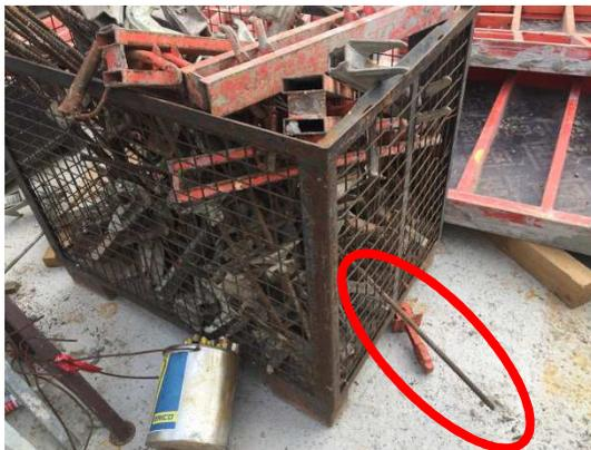
Probleme bei für den Kranbetrieb zugelassenen Gitterboxen:
