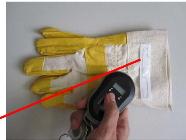
...kann das Vorhandensein der benötigten PSA mittels RFID-Leser überprüft werden.
