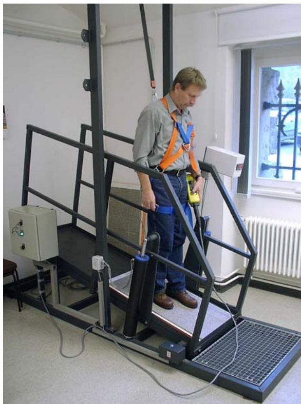
Anh. A, Abb. 1 Begehungsverfahren auf der Schiefen Ebene nach DIN 51130
