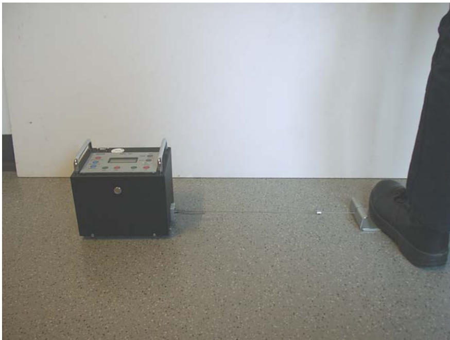
Abb. 13.1 Gleitreibungsmessgerät GMG 100 nach E DIN 51131
