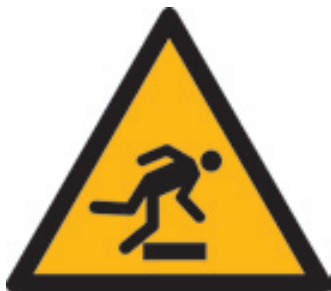
Abb. 21 W007 Warnung vor Hindernissen am Boden
