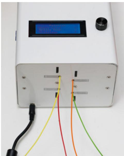
Mit diesem Splicer lässt sich bei nur einer Druckdüse mit verschiedenen Filamenten zugleich und damit mehrfarbig drucken.
