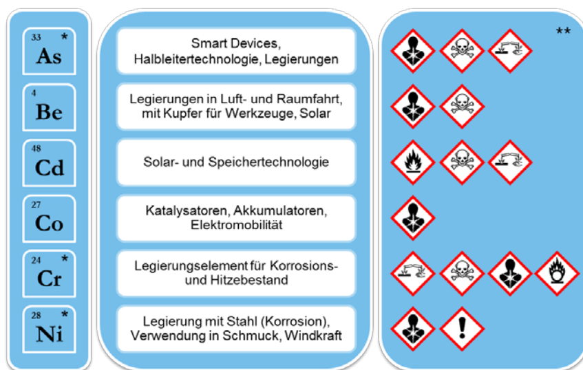
Abb. B 15: Arsen, Beryllium, Cadmium, Cobalt, Chrom und Nickel – Verwendung und Gesundheitsgefahren
