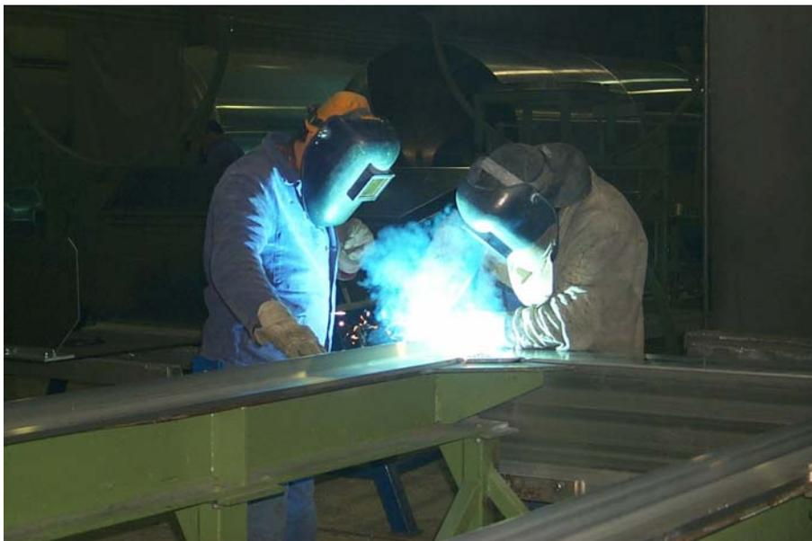
**Abb. 2.9** Schweißarbeiten mit dem MIG-Verfahren an einem Aufliegergestell
