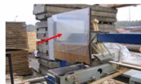
Abb. 6 - Durch den Entfall von beiden Blechplatten fast angebrochen primärer Schutzverriegelung
