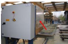
Abb. 1 - Mehrfach-Abblängsäge MAS-6,5-6-4 ● soll einen nachgerüsteten primären Schutz vor Gegenstände (Werkstücke)
