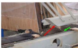
Abb. 4 - ● Ein Werkstück mit Schnittfläche 100 mm Höhe schwebt auf Krantisch voran ● Fehlsack Werkstückrückschlagverriegelung (Spaltmaß)
