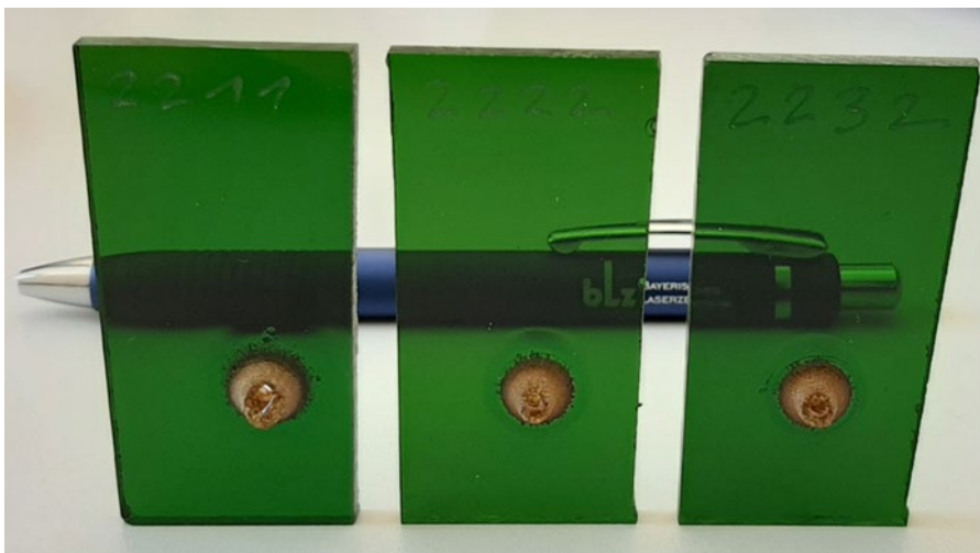
Abb. 5.4 PMMA-Filter nach Laserbelastungsprüfungen mit dem cw-Nd:YAG-Laser bei 1064 nm mit 30 W; links ungealtert, Mitte 50 h UV-gealtert, rechts 200 h UV-gealtert
