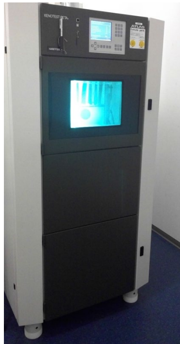
Abb. 3.8 Belichtungs- und Bewitterungsprüfgerät „Xenotest Beta+“ der Firma Atlas zur künstlichen Alterung der Filter mittels künstlicher Bewitterung mit Xenonlicht
