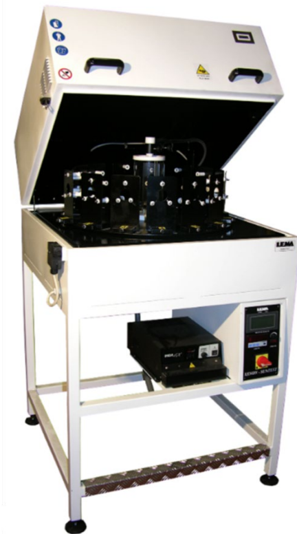
Abb. 3.6 Prüfeinrichtung „Xenon Suntest“ von LEMA s.r.l. zur UV-Alterung der zu prüfenden Filter
