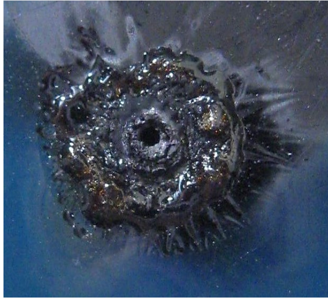
Abb. 5.9 Schadensbild an 200 h UV-gealtertem PC-Filter nach Laserbelastungsprüfung mit dem gepulsten Nd:YAG-Laser bei 1064 nm mit 14,8 W
