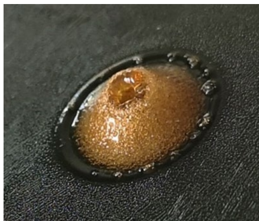
Abb. 5.6 Schadensbild an 600 h UV-gealtertem PMMA-Filter nach Laserbelastungsprüfung mit dem cw-Nd:YAG-Laser bei 1064 nm mit 30 W; gut erkennbar ist die durch die lange UV-Bestrahlung deutlich aufgeraute Oberfläche des Filters
