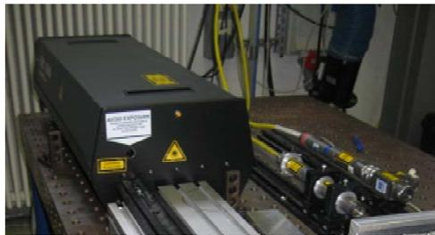
**Abb. 3.5** Frequenzverdoppelte Nd:YAG-Laserstrahlquelle ORC 1000 der Fa. Clark**Tab. 3.5** Technische Daten der gepulsten Nd:YAG-Laserstrahlquelle (532 nm)
