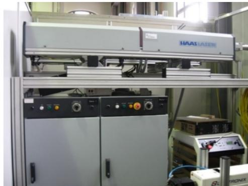
**Abb. 3.1** cw-Nd:YAG-Laserstrahlquelle QY-1000D der Fa. HAAS Laser
