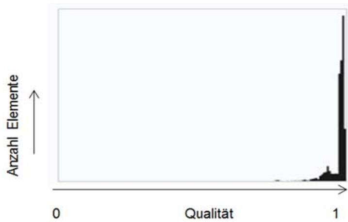
**Abb. 7.10** Histogramm zur Elementqualität bei 2-D Geometrie
