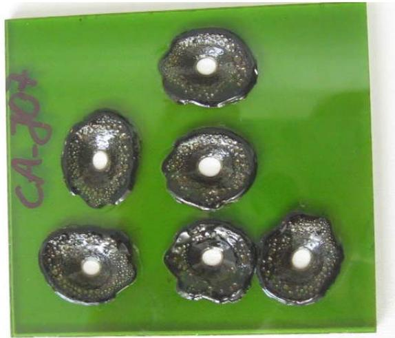
**Abb. 5.31** Schadensbilder von Standzeitversuchen an CA-Filtern mit dem CO<sub>2</sub>-Laser bei einem Strahldurchmesser  $d_{63}$  von 10 mm bei 10600 nm
