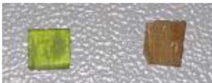
**Abb. 7.1** PMMA-Filter links im Ausgangszustand, rechts nach Erhitzung auf 330°C
