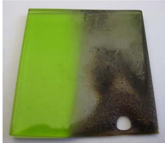
**Abb. 5.28** Verbrannte PMMA-Probe nach Laserbelastungsprüfung mit hoher Leistung und großem Strahldurchmesser am CO<sub>2</sub>-Laser
