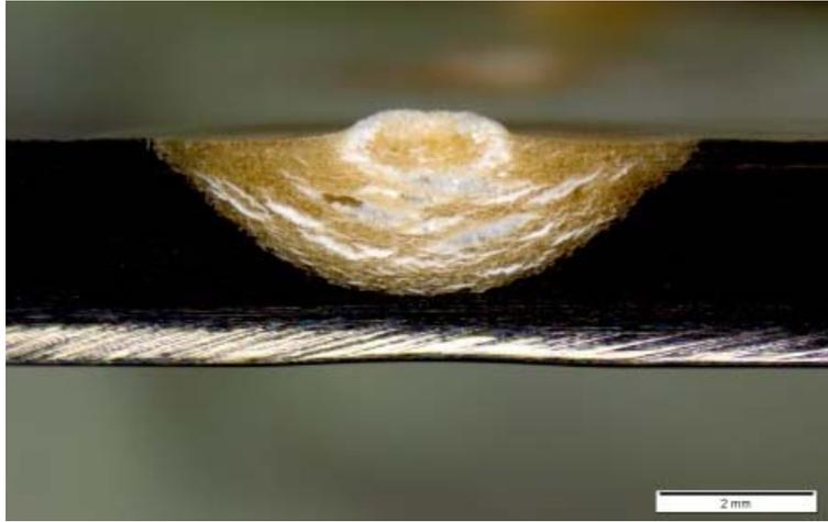
**Abb. 5.7** Querschnitt in PMMA durch die bestrahlte Stelle; Strahldurchmesser 1 mm; Laserleistung 157 W im cw-Laserbetrieb bei 1064 nm; Bestrahlung bis zum Filterversagen (Unterbrechung des Lasersicherheitskreises durch den LaserSpy<sup>®</sup>-Sensor)
