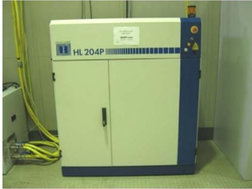
**Abb. 3.3** Gepulste Nd:YAG-Laserstrahlquelle HL 204 P der Fa. TRUMPF
