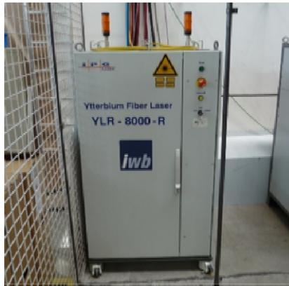
**Abb. 3.2** cw Ytterbium-Faserlaser-Strahlquelle YLR - 8000-R der Fa. IPG Laser
