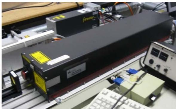
**Abb. 3.4** Gepulste CO<sub>2</sub>-Laserstrahlquelle Diamond K150 der Fa. Coherent
