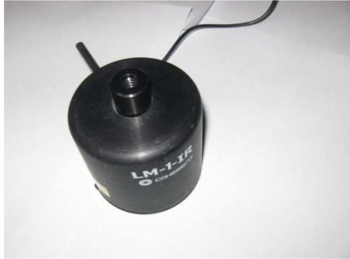
**Abb. 3.7** Leistungsmesskopf LM-1 IR der Fa. Coherent
