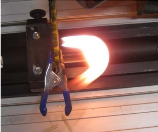
**Abb. 5.27** Massive Flammenbildung bei Laserbelastungsprüfungen am CO<sub>2</sub>-Laser mit hoher Leistung und großem Strahldurchmesser
