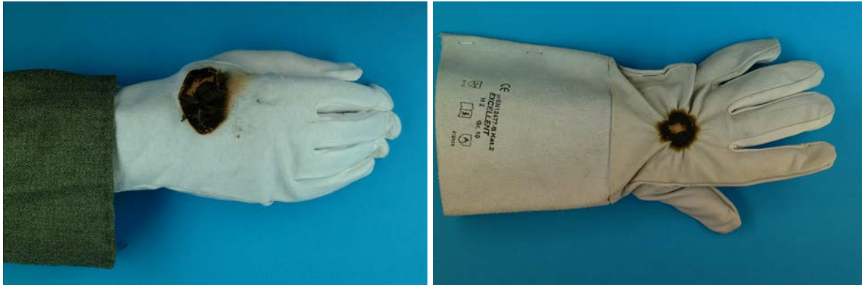
Abb. 5.14 Aufnahmen von Handschuhen, die mit einem CO 2 -Laser bestrahlt wurden leichter Baumwollhandschuh Schweißerschutzhandschuh E = 2,7 \cdot 10^5 \text{ W/m}^2 E = 3,7 \cdot 10^5 \text{ W/m}^2 Flammenbildung: 1,5 s Schrumpfen: sofort Lochbildung: 2 s Lochbildung: 5,5 s
