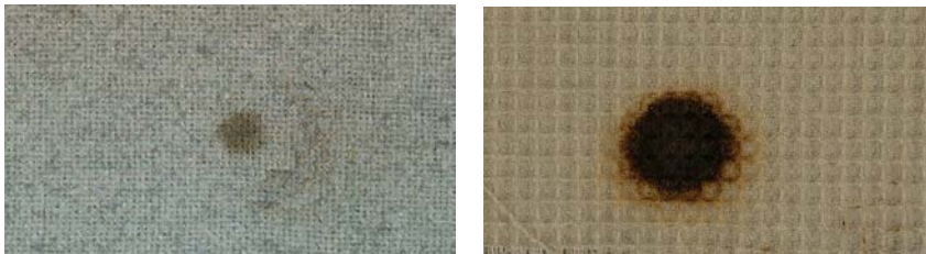
Abb. 6.16 Aluminisiertes Kevlargetze (Rückseite: Waffelpique); links: bestrahlte Vorderseite; rechts Rückseite
